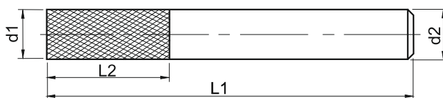
Многозубые твердосплавные фрезы — средняя насечка, сход стружки вверх
