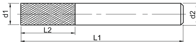
Многозубые твердосплавные фрезы — средняя насечка, сход стружки вниз
