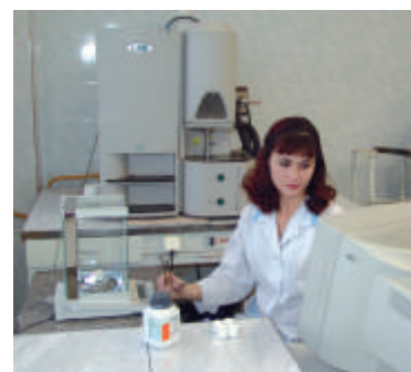
Для точного определения содержания углерода, кислорода, азота и серы используется оборудование фирмы “LECO”
